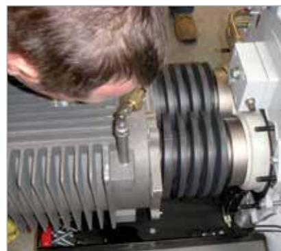
Благодаря простой разборке камеры насосы SCREWLINE могут очищаться на месте пользователем
